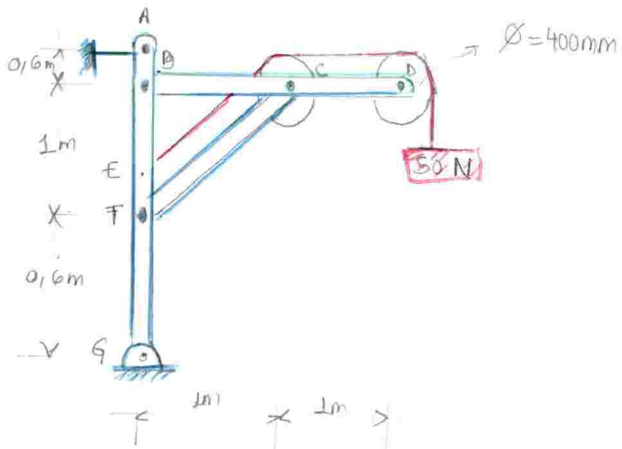
Calcule reacciones en los soportes y la tensión en  $T_{FC}$
