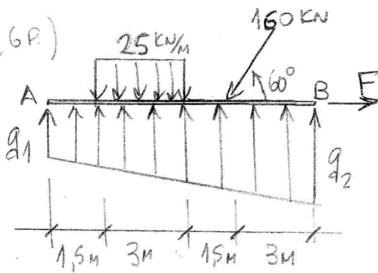
CALCULAR LOS VALORES DE F,  $q_1$  Y  $q_2$  PARA QUE EL SISTEMA PLANO DE FUERZAS QUE ACTÚA SOBRE LA BARRA RÍGIDA AB (DE PESO PROPIO DESPRECiable) ESTÉ EN EQUILIBRIO.
