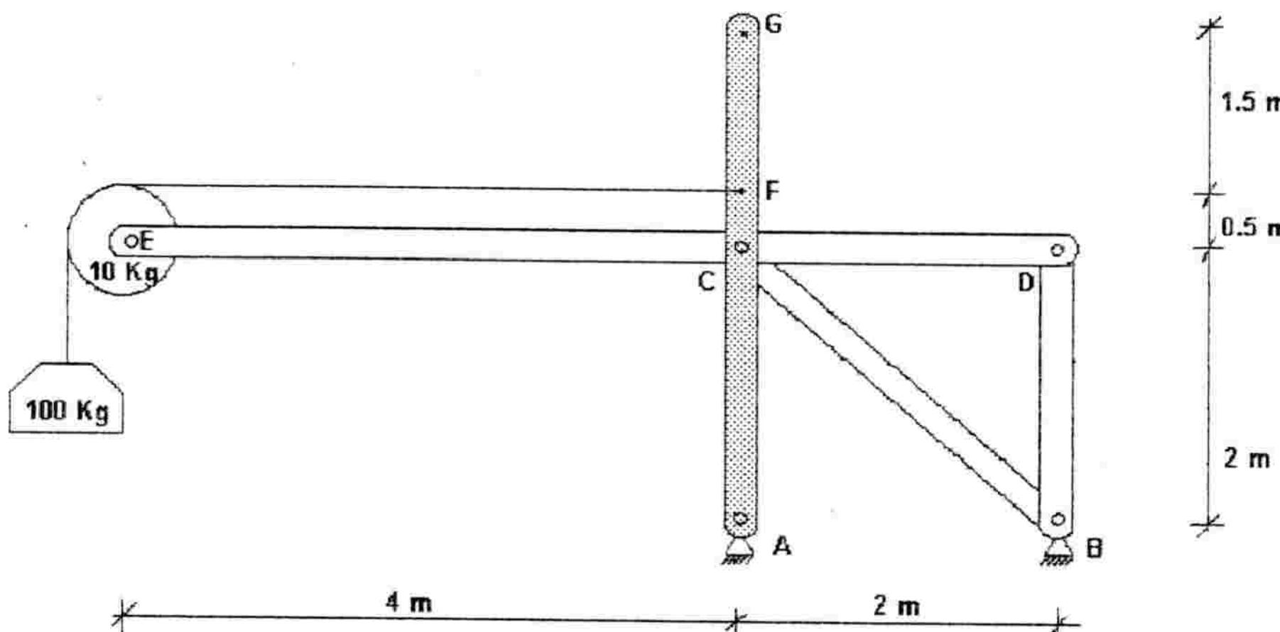
Dado el sistema estructural compuesto por las barras de pesos despreciables AG, ED, BD y CB y la polea de peso 10 Kg. ubicada en el punto E; se pide:
